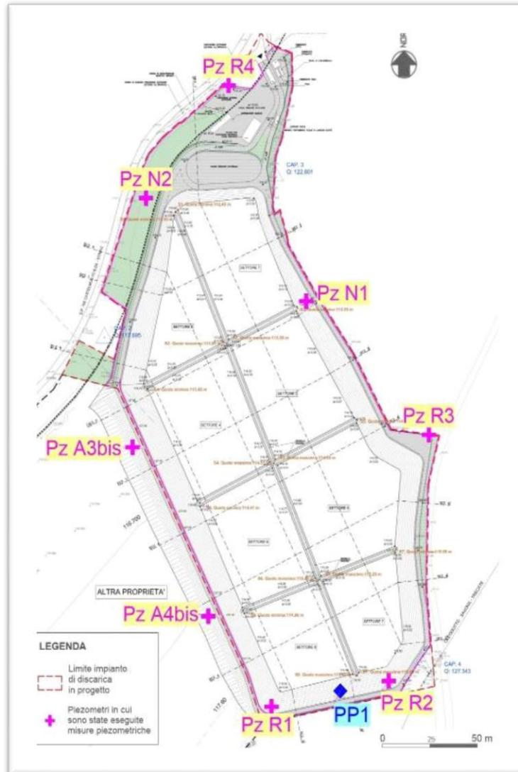
Figura 22: Ubicazione piezometri in sito per monitoraggio acque sotterranee
